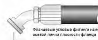
Все угловые фитинги с накидной гайкой измеряют по верхней точке оси фитинга
