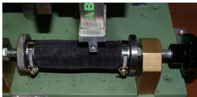
Fig. 1 – Prova di abrasione secondo UNI ISO 6945. Abrasion Test in accordance with UNI ISO 6945 Standard.
