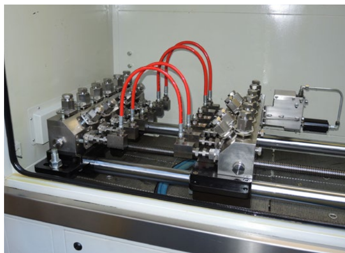
Banco per prova ad impulsi secondo norma SAE (interno) Bench for impulse pressure test according to SAE standard (inside)
